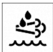
Luz de advertencia del sistema de inyección de DEF/AdBlue
