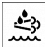
Luz de advertencia del sistema de inyección de DEF/AdBlue
