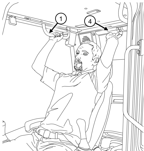
Parabrisas abierto y enganchado en la posición debajo del techo
